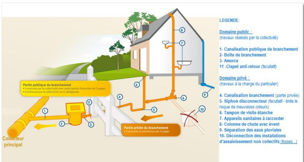
**Figure 1 : Schéma de principe d'un raccordement sur système de collecte de type séparatif**
