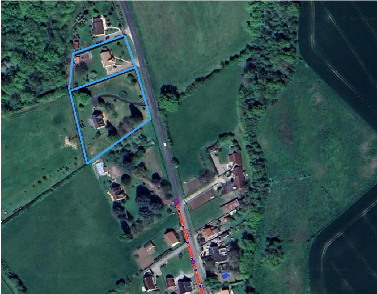
La mise en place d'une extension du réseau d'assainissement collectif afin de raccorder ces deux habitations nécessiterait la pose **d'environ 180 ml de conduites** pour un coût **d'environ 67 000 €**.
